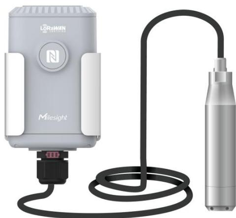
EM500-SWL 传感器是一款设计简约美观、功能强大的投入式液位传感器。EM500-SWL 传感器采用专用传感器调理电路，结合先进的压阻式压力变送器设计制造技术，能够实时监测液位，并通过无线 LoRaWAN<sup>®</sup> 通信技术传输到远程平台。
